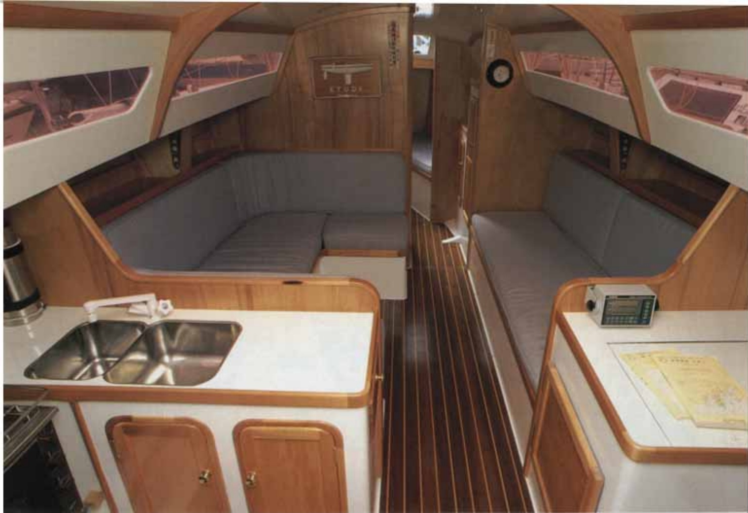
●長さ4mもある長大なドッグハウスのお陰でヘッドクリアランスは1.87mと高い。メインサロンの中央、天井左右から出ている大きなニーが木造船の特徴を物語る。サイドシュラウド用のチェーンプレートが取り付けられているニーは、フロア材がそのまま上がってきたらしく厚みが何と9cmもあった
