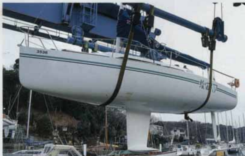
■長いワイルダカ意外とフリーボードは高い。キール先端のウイングの幅はそんなに広くない。重心を下げるためのワイルド形状を少しでも効果的のよいウイング状にしたためか、キールの大きさに比べるとラダーの前縁幅が狭くエリアも小さい
