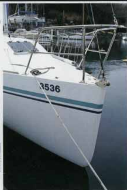
■標準になったシステム、システム下部のナットは完全に水に出ている。フォアステイは6mのワイルド、タービンバックルはグラハム、パワーホックはなく、標準クリートに勝つ。システムヘッドには小さなタンクローラーがついている
