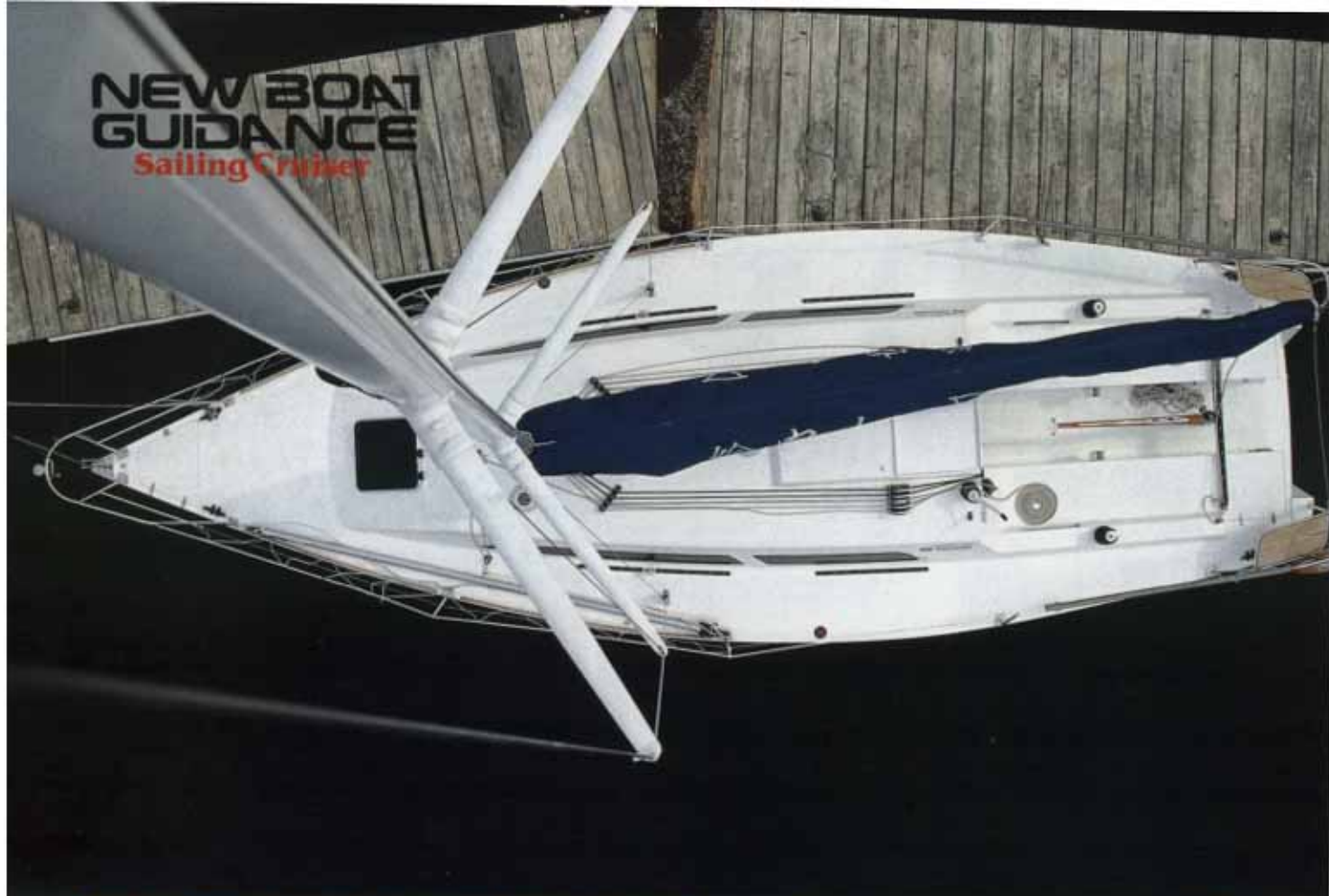
■フィッティング類がほとんど見当たらない。特にクリーンなデッキ、サイドシュラウドのスウィングバックは1.1mにもおよぶが、このお陰でランナーもパーマネントバックステイも不要になっている
